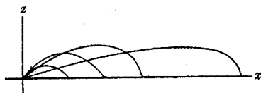
شکل ۳-۲۹ مسیرهای حداکثر برد برای گلوله‌هایی که دارای سرعت دهانه‌ای مختلف‌اند.
